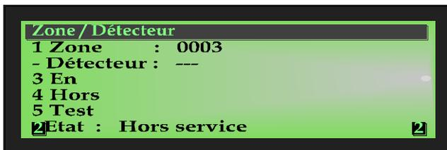
Fig. 39 : Affichage de la mise hors service de la zone 3 (exemple)
