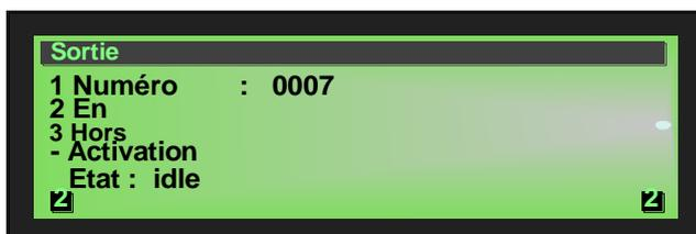
Fig. 45 : Affichage "Sortie 7 va être activé / réinitialisé" (exemple)
