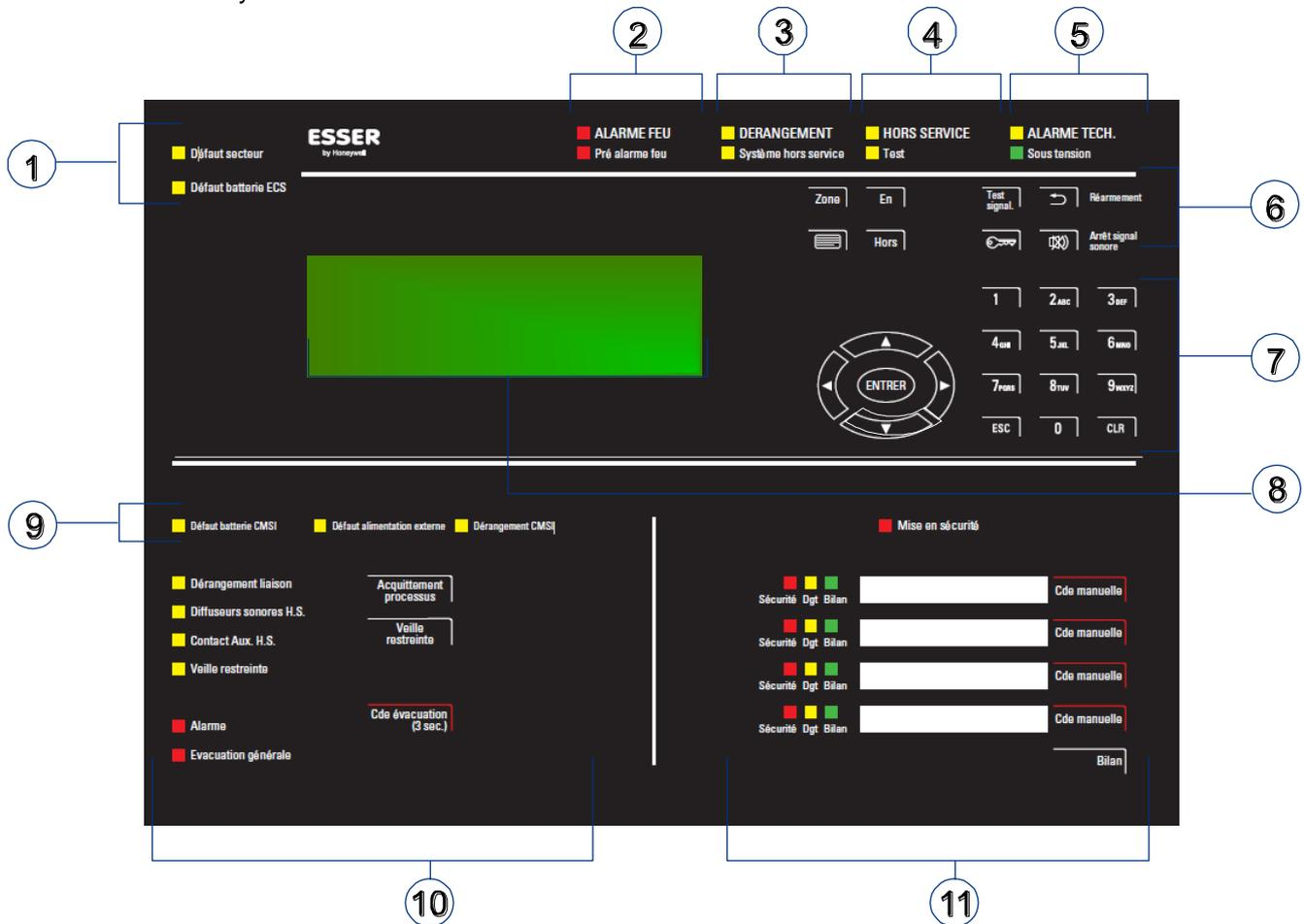
Fig. 1 : Aperçu des éléments d'affichage et de commande
